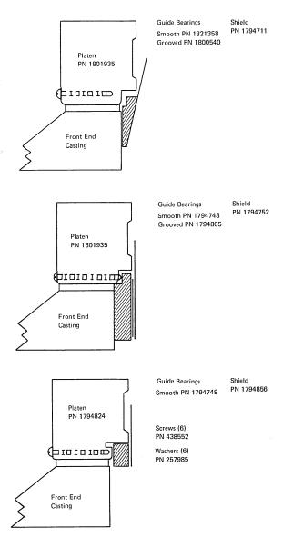
Figure 7-7. Platen Assembly
